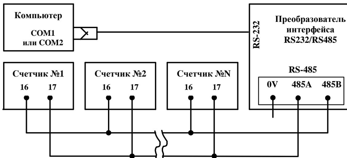
Рекомендации по организации канала связи между преобразователем интерфейса и счетчиками:
